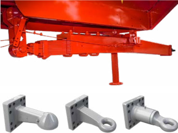
Disponible en modelos E88KMP2 y E92KMP2. Eje balancín cuadrado 100mm, vía 1900, 10 esp., tambor freno 400x80.
