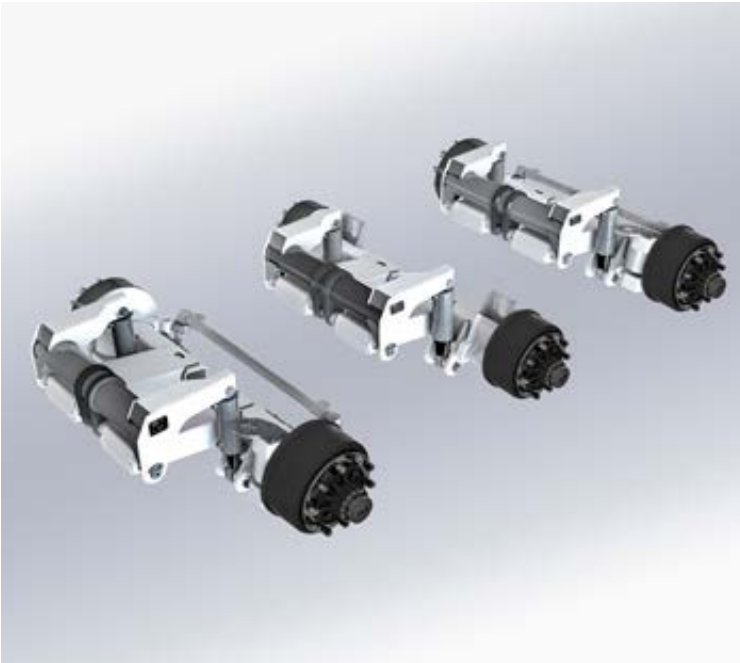
Disponible en modelos E95KMP2. De serie: Eje suspensión bogie autodireccional en segundo eje cuadrado 150mm, 26K, vía 2000, 10 esp., tambor freno 400x120. En opción: Eje sidra triple direccional forzado en primer y tercer eje comandado con cilindro enganchado al tractor, vía 2000, 10 esp., tambor freno 400x120. Según norma ISO 26402. Eje sidra triple direccional forzado en primer y tercer eje comandado electrónicamente, vía 2000, 10 esp., tambor freno 400x120 Eje sidra triple direccional forzado en primer, segundo y tercer eje comandado electrónicamente, vía 2000, 10 esp., tambor freno 400x120. Nota: Inc
