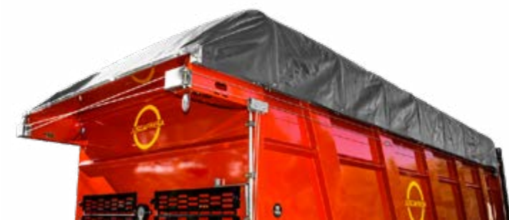
Ganchos para toldo. Toldo superior con guías para proteger la carga accionado manualmente. Nota: solo apto con tapa hidráulica apertura vertical tipo guillotina. Toldo superior con guías para proteger la carga accionamiento neumático o eléctrico a través de mando a distancia vía cable. Nota: solo apto con tapa hidráulica apertura vertical tipo guillotina.
